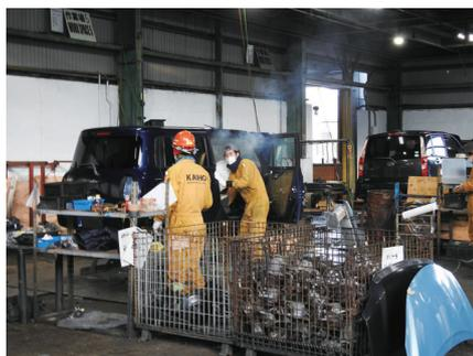
【図3】エアバッグを作動させた瞬間
