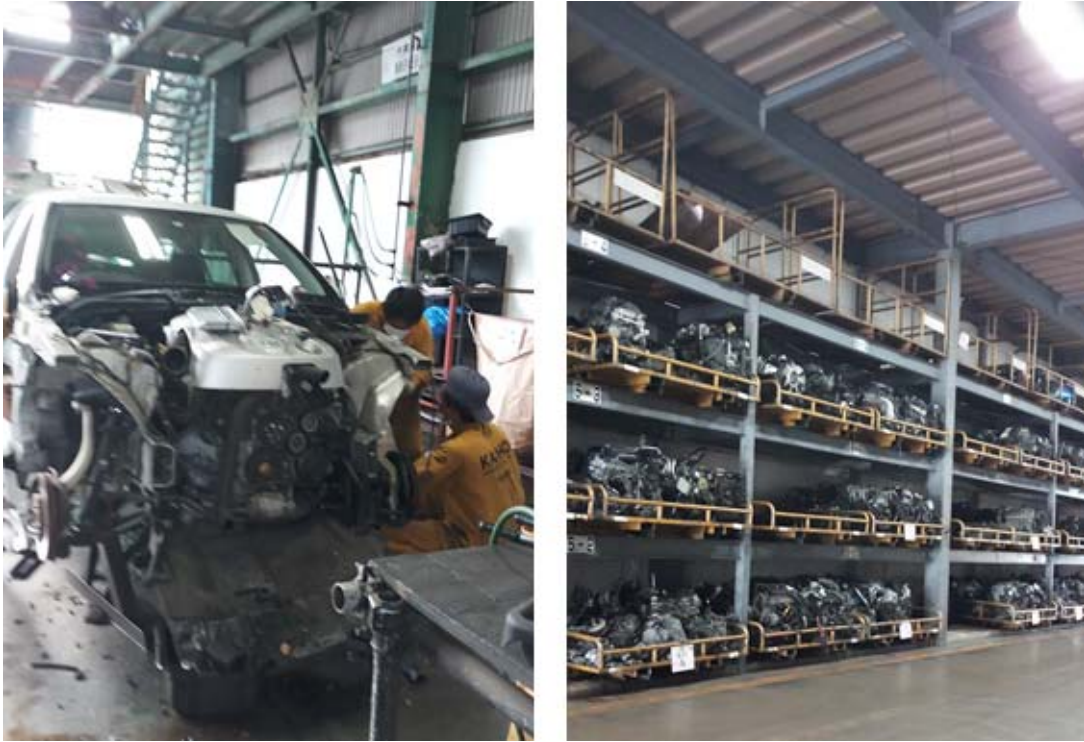
(解体作業後、部品ごとに保管される)
